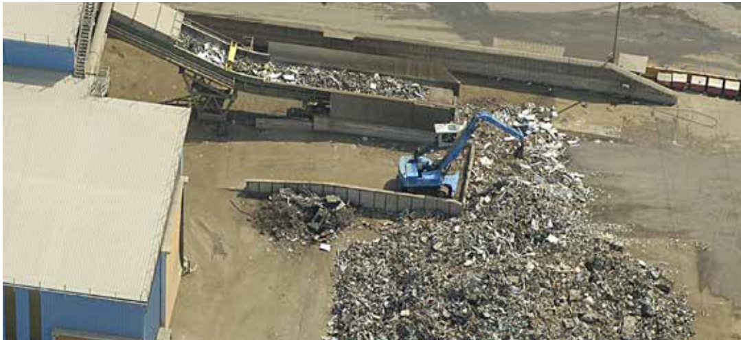
Rottame in fase di caricamento al frantumatore
