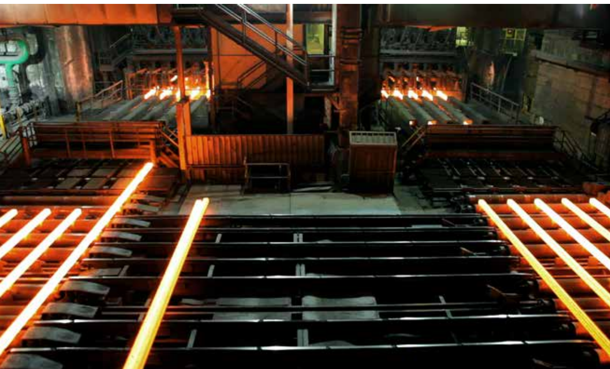
Macchine da colata continua
